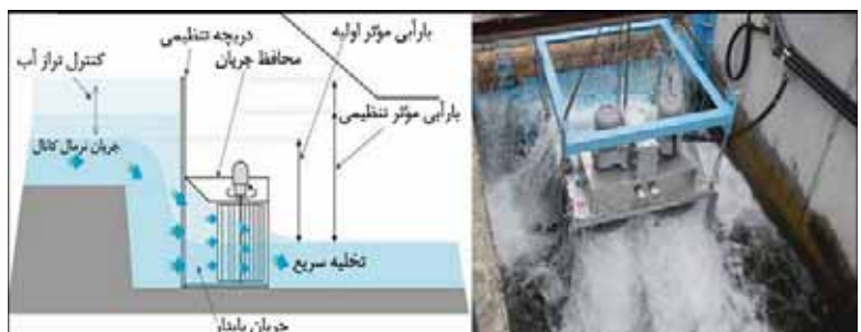
نیروگاه برق آبی میکرو، بعد از یک دراپ در کانال و استفاده از انرژی جریان، ژاپن
