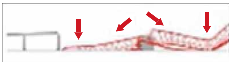
شکل شماره ۹: خرابی اعضای بالایی خراب.
