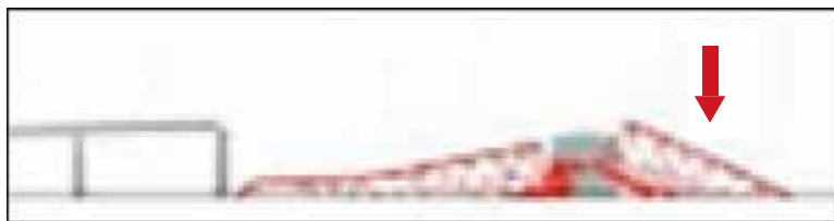
شکل شماره ۱۰: فروریزش دهانه میانی و دهانه شمالی
