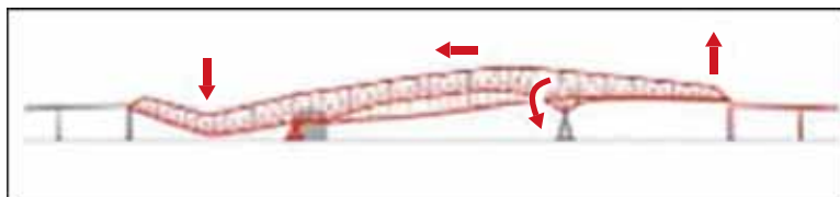
شکل شماره ۸: پایه جنوبی شروع به خراب شدن می‌کند، حذف عملکرد قوسی خراب و دو برابر شدن دهانه خراب.
