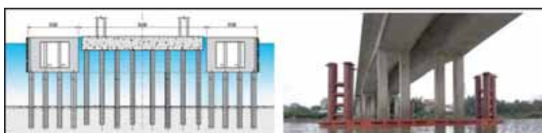
شکل شماره ۱۴: شمع‌ها و پایه‌های ضد برخورد
